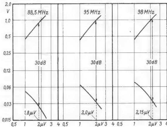
Bild 6. Rauschabstand im UKW-Bereich, gemessen über die Autoantennenbuchse
