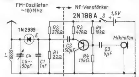
Bild 4. „Drahtloses“ Mikrofon mit Esaki-Diode für den UKW-Bereich nach einem Schaltungsvorschlag der General Electric Co., USA
