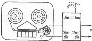
Bild 1. Anschluß des Diamaton an ein Tonbandgerät; K = Kontaktgeber, mit Saugnapf am Tonbandgerät befestigt, P = Anschlüsse zum Projektor
