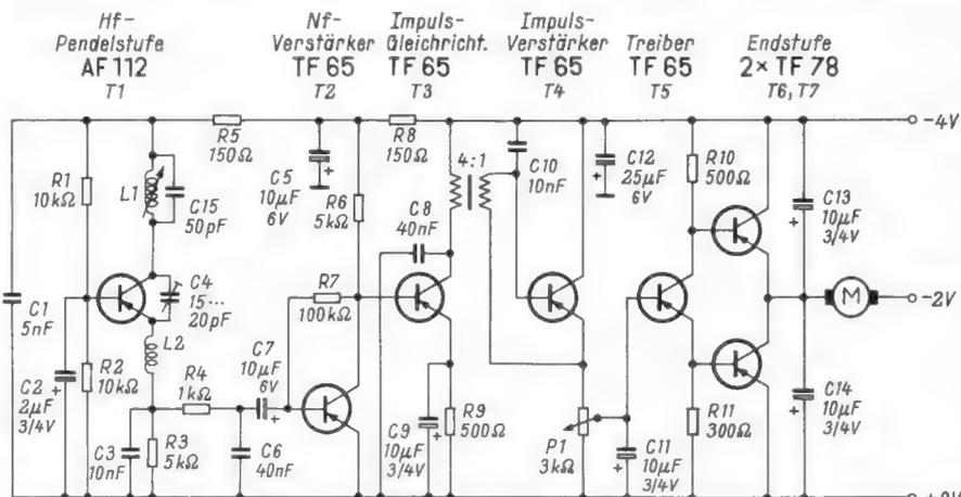
Bild 5. Schaltung des Musterempfängers; sämtliche Widerstände 0,1 W, P 1 = Subminiaturpotentiometer
