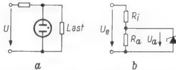
Bild 8. Stabilisationsschaltungen mit Röhre und Zenerdiode;  $R_i$  wird in der Praxis zum Teil durch einen Vorwiderstand dargestellt
