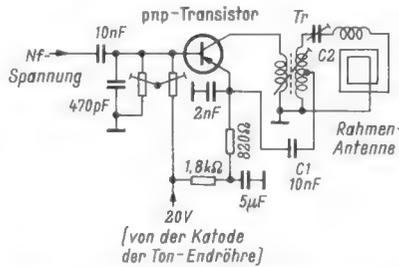
Schaltbild eines zusätzlichen Kleinstsenders für die Fernseh-Tonübertragung auf einen MW-Empfänger
