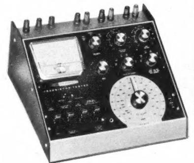
**Meßmöglichkeiten:** Basisstrom, Stromverstärkung, Kollektorspannung, Kollektorstrom, Restspannung, Kurzschlußprüfung, Kollektor-Basis-Reststrom, Kollektor-Emitter-Reststrom; bei Dioden Durchlaß- und Sperrstrom; Maße: 275 x 260 x 130 mm (pultförmig); Gewicht: 3,5 kg.
