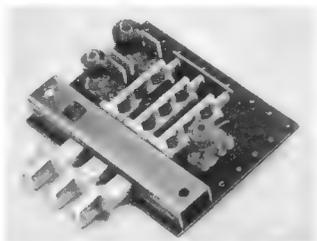
Bild 10. Besonders flacher Schalterblock mit gedruckter Platine mit drei (oder auch mehr) Drucktasten von Orega
