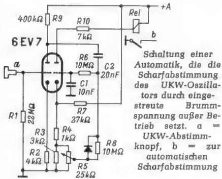
Schaltung einer Automatik, die die Scharfabstimmung des UKW-Oszillators durch eingestrichelte Brummspannung außer Betrieb setzt. a = UKW-Abstimmknopf, b = zur automatischen Scharfabstimmung
