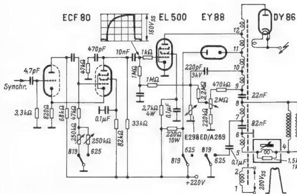
Bild 5. Horizontal-Ablenkteil mit umschaltbarer Zeilenfrequenz für einen 819/625-Zeilen-Fernsehempfänger (Vorschlag von Arena)
