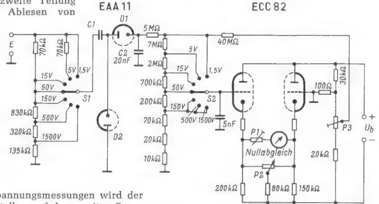
Für Gleichspannungsmessungen wird der Eingang unmittelbar auf den zweiten Spannungsteiler durchverbunden. Der Eingangswiderstand beträgt dann rund 10 M $\Omega$ , und es ergeben sich unter Verwendung eines Schalters S 3, der dann auch die Abgriffe an dem 20-k $\Omega$ - und 10-k $\Omega$ -Widerstand abtastet, die gleichen Meßbereiche wie bei Wechselspannung.
