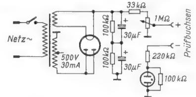
Schaltung des Hochspannungsnetztes zur Prüfung von Isolationswiderständen mit der Glühmöhre
