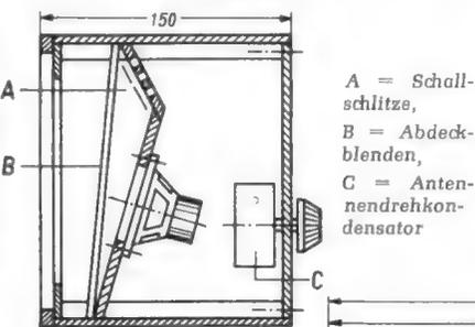
Bild 4. Der Schnitt durch die Lautsprecherbox verdeutlicht das Prinzip des Lautsprechereinbaus
