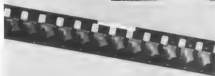
Links: Bild 5b. Die Folie wird am Perforationssteg auf der Schichtseite des Filmes angebracht
