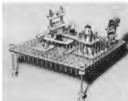
Bild 16. Baukasten Planelec für den Elektronik-Unterricht (La Technique Electronique)
