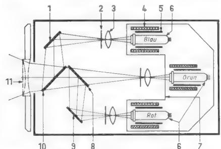
Bild 2. Strahlengang und Anordnung der drei Vidikons in der Farbkamera gemäß Bild 1. 1 = Oberflächen-Spiegel, 2 = Korrekturfilter, 3 = 80-mm-Objektivlinse mit  $f = 1 : 1,4$ , 4 = Fokussierungsspule, 5 = Ablenkspule, 6 = Vidikon-Aufnahmeröhren, 7 = Fokussier-Träger, 8 = dichroitischer Spiegel (rotreflektierend), 9 = Oberflächenspiegel, 10 = dichroitischer Spiegel (blauflektierend), 11 = farbkorrigiertes Objektiv
