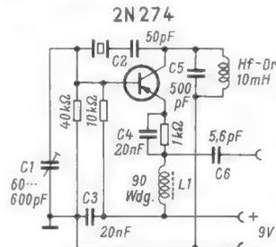
Schaltung eines 100-kHz-Frequenznormals mit einem Transistor 2 N 274 oder einem ähnlichen Typ
