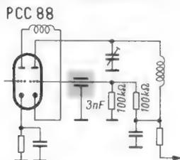
Ein Feinschluß des Durchführungskondensators C war die Fehlerursache. Dadurch fehlte am Gitter der Kaskodenstufe die erforderliche positive Spannung und die Röhre war infolge des hohen Potentials an der Katode gesperrt
