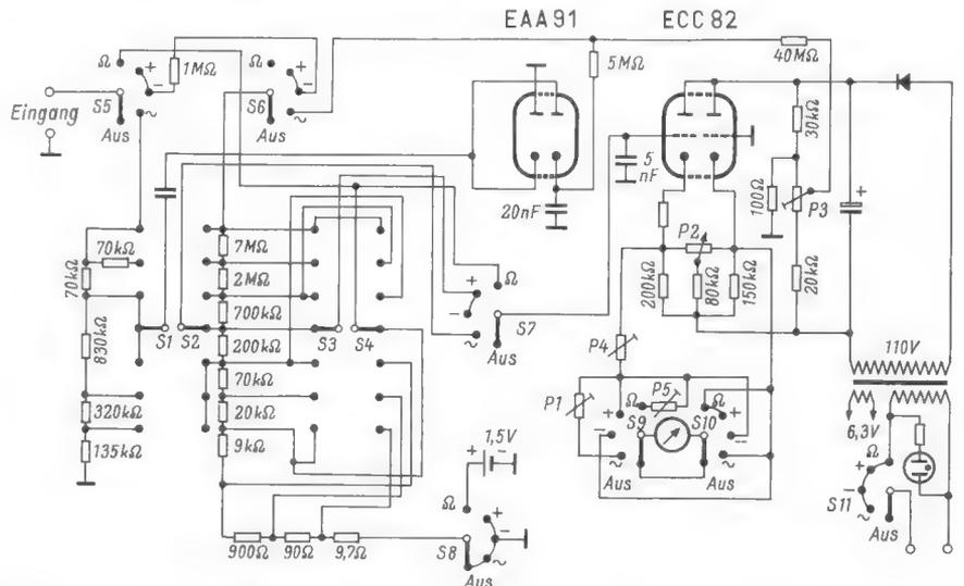
Bild 4. Gesamtschaltung des Röhrenvoltmeters, die Schalter S 1 bis S 4 sowie die Schalter S 5 bis S 11 sind untereinander gekuppelt; P 1 = Eichung (Vollausschlag) für die Wechselspannungsbereiche, P 2 = Nullstellung, P 3 = Nullstellung für Wechselspannung (Diodenanlaufstrom-Kompensation), P 4 = Eichung für Gleichspannung (Vollausschlag), P 5 = Eichung für Widerstandsmessungen (Vollausschlag bei kurzgeschlossenen Meßleitungen einstellen)
