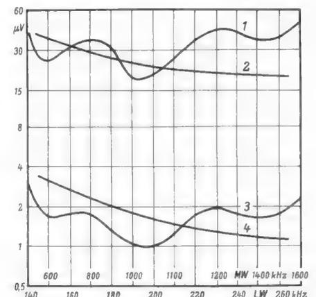
Bild 4. Oben: Eingangsempfindlichkeiten für 500 mW, 1 = MW, 2 = LW; unten: Signal/Rauschabstand nach Ensi, 3 = MW, 4 = LW
