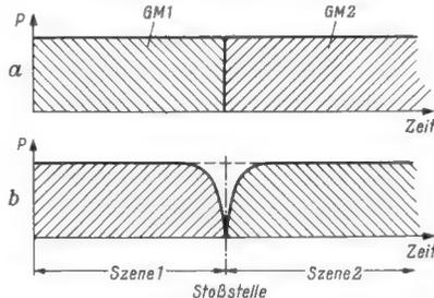
Bild 7. a: Vor dem Einwirken der Wischblende sind die Grunduntermalungen im „harten Stoß“ zusammengesetzt; b: Bei einem nachfolgenden Durchlauf des Filmes wurde der Übergang weich verwischt
