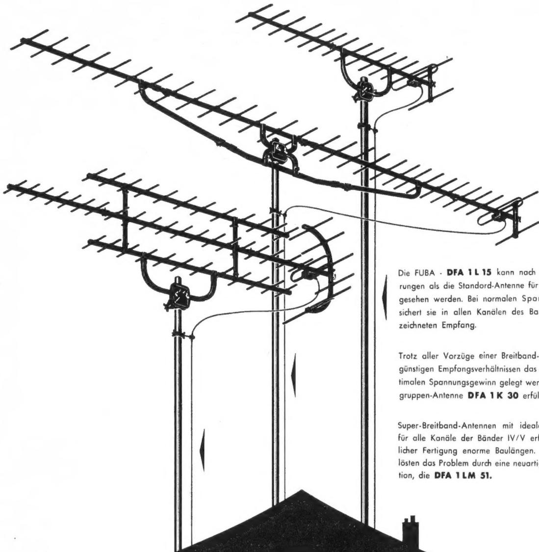
Die FUBA - **DFA 1 L 15** kann nach den bisherigen Erfahrungen als die Standard-Antenne für das 2. Programm angesehen werden. Bei normalen Spannungsverhältnissen sichert sie in allen Kanälen des Bandes IV einen ausgezeichneten Empfang.
