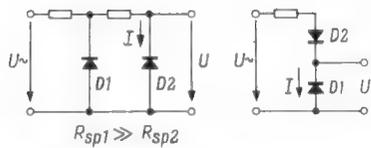
Bild 5. Schaltungen zur logarithmischen Gleichrichtung
