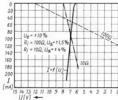
Bild 9. Kennlinienfeld mit Widerstandsgeraden zur Arbeitsweise der Zenerdiode; ausgezogene Kurve = Kennlinie der Zenerdiode, gestrichelt = Arbeitskennlinien
