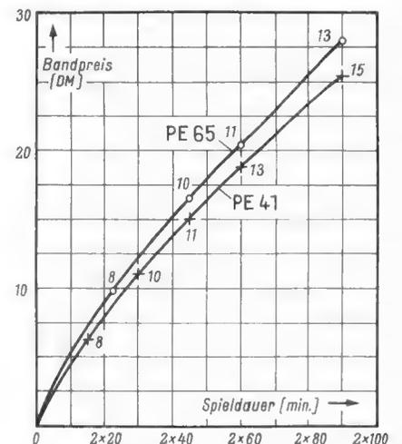
Bandpreis in Abhängigkeit von der Spieldauer beim Triple-Band Pe 65 und beim Doppelspiel-Band Pe 41; Spielzeiten für 9,5 cm/sec Doppelspur; die Zahlen an den Kurven bedeuten die Spulendurchmesser
