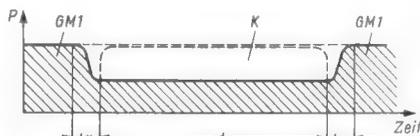
Bild 2. Magnetogramm nach Einwirken der Trickblende. Während der Zeit t hat der Aufsprechvormagnetisierungsstrom das vorherige Magnetogramm GM 1 teilweise gelöscht. Der Kommentar K hat keinen Einfluß auf das „Auslösen“ der Grundmusik, die allmählich während der Übergangszeit  $t_u$  (etwa 0,5 sec) an- und abschwellen soll
