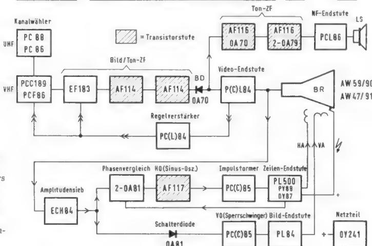
Blockschema des Radione-Hybrid-Fernsehempfängers (5 Transistoren, 12 Röhren). Die Transistorstufen sind durch Schraffur gekennzeichnet
