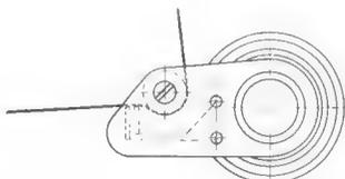
Bild 2. Tonbandlauf durch den Kontaktgeber; die beiden gestrichelt dargestellten Federn werden von der Kontaktfolie überbrückt
