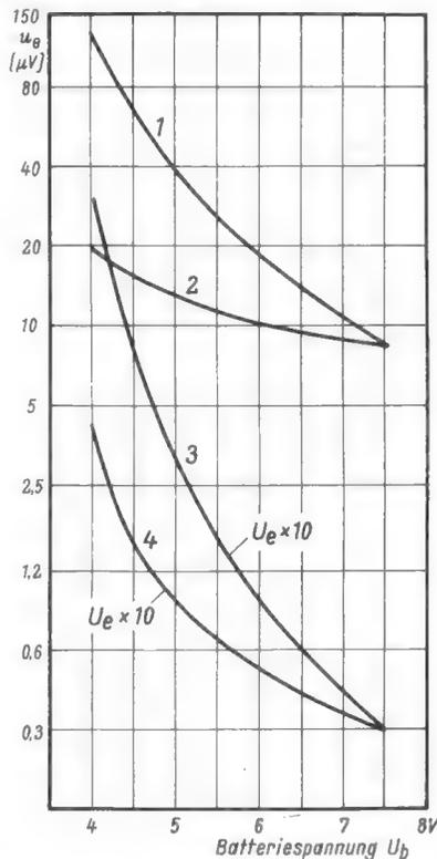
Bild 7. Eingangsempfindlichkeit in Abhängigkeit von der Batteriespannung, gemessen über die Autoantennenbuchse, bei MW für 50 mW Ausgangsleistung, bei UKW für 1 V Richtspannung
