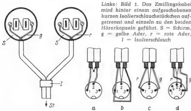
Links: Bild 1. Das Zwillingskabel wird hinter einem aufgeschobenen kurzen Isolierschlauchstückchen aufgetrennt und einzeln zu den beiden Hörekapseln geführt. S = Schirm, g = gelbe Ader, r = rote Ader, I = Isolierschlauch
