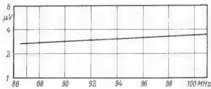
Bild 5. Eingangsspannung für 1 V Richtspannung am Ratio-Detektor
