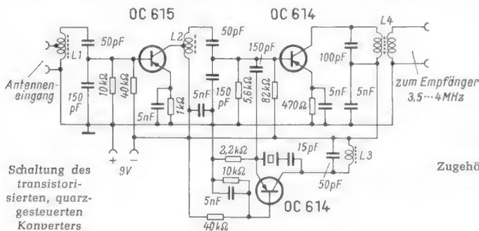
Schaltung des transistorisierten, quarzgesteuerten Konverters
