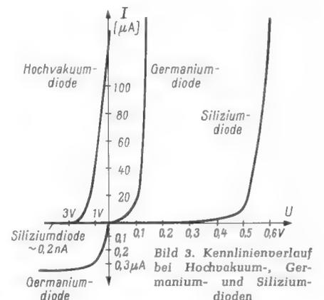
Bild 3. Kennlinienverlauf bei Hochvakuum-, Germanium- und Siliziumdioden
