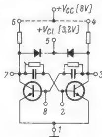
Bild 2. Diese Flip-flop-Schaltung mit zwei Transistoren und zwei Diolen findet Platz...
