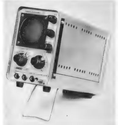
Bild 17. Service-Oszillograf 377 von Centrad; zum Transport mit Deckel und Trageriemen ausgestattet
