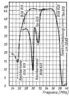
Bild 6. Durchlaßkurve eines umschaltbaren Fernsehempfängers
