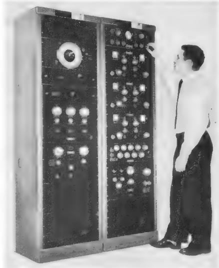
Bild 3. Die Frequenzmeßeinrichtung 1105-B (rechts) und das Frequenznormal 1120-AH (links)
