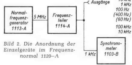
Bild 2. Die Anordnung der Einzelgeräte im Frequenznormal 1120-A
