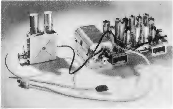
Bild 7. Multistandard-Chassis mit UHF-Tuner, Kanalschalter und Zf-Verstärker (Vidéon)
