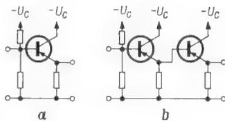
Bild 7. Eingangsschaltungen mit Transistoren
