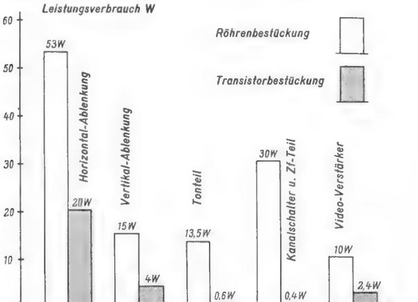
Bild 8. Vergleich des Leistungsverbrauchs der einzelnen Stufen eines volltransistorisierten und eines röhrenbestückten Fernsehempfängers (nach Cossem und Radio-Belvu)
