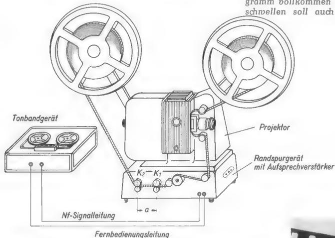
Bild 4. Vertonungs-Anlage bei einem 8-mm-Projektor. An den Kontaktstellen  $K_1$  und  $K_2$  des Randspurgerätes schaltet eine am Film angebrachte Stanniofolie ein Fortschaltrelais. Der Kontakt  $K_2$  ist bei 16 Bildern je Sekunde in etwa 3 cm Abstand von Kontakt  $K_1$  in Filmlaufrichtung versetzt. Bei 24 Bildern je Sekunde beträgt der Abstand a rund 4,5 cm
