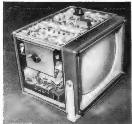
Bild 9. Handlicher Volltransistor-Fernsehempfänger für Batterie- und Netzbetrieb (Labormuster von SESCO)
