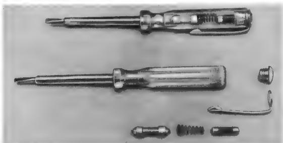
Zerlegbarer Spannungsprüfer mit Schraubenzieher, untere Reihe von links nach rechts: Glimmröhre, Druckfeder, Vorschaltwiderstand
