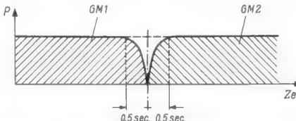
Bild 3. Magnetischer Wischvorgang für „weiche“ Stoßstellen. Der Vormagnetisierungsstrom hat eine solche Intensität, daß er das erste Magnetogramm vollkommen auslöscht. Das An- und Abschwellen soll auch hier automatisch erfolgen
