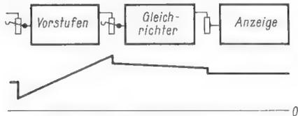
Bild 6. Grundaufbau und Pegeldiagramm von Röhrenvoltmetern
