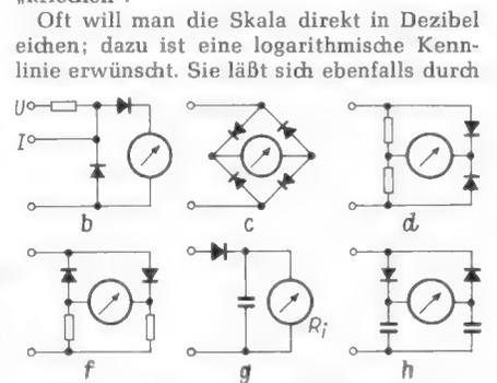
Bild 2. In Meßgeräten gebräuchliche Gleichrichterschaltungen
