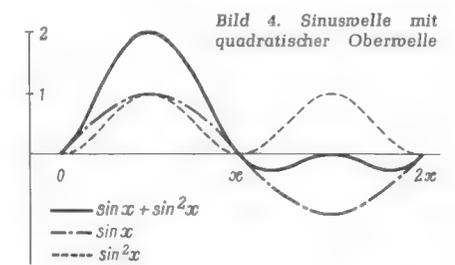
Bild 4. Sinuswelle mit quadratischer Oberwelle
