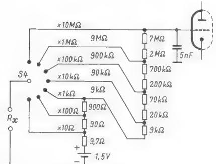
Bild 3. Teilschaltung für Widerstandsmessungen
