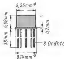
Bild 3. ... in dieser Transistorkapsel TO 5 mit nur 8 1/4 mm Durchmesser (General Instrument)
