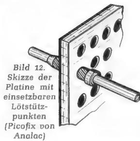
Bild 12. Skizze der Platine mit einsetzbaren Lötstützpunkten (Picofix von Analac)
