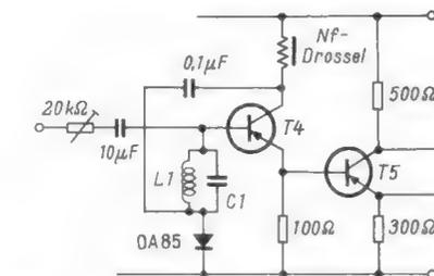
Bild 7. Selektive Gleichrichterstufe. Die Daten des Kreises errechnen sich aus der Formel
